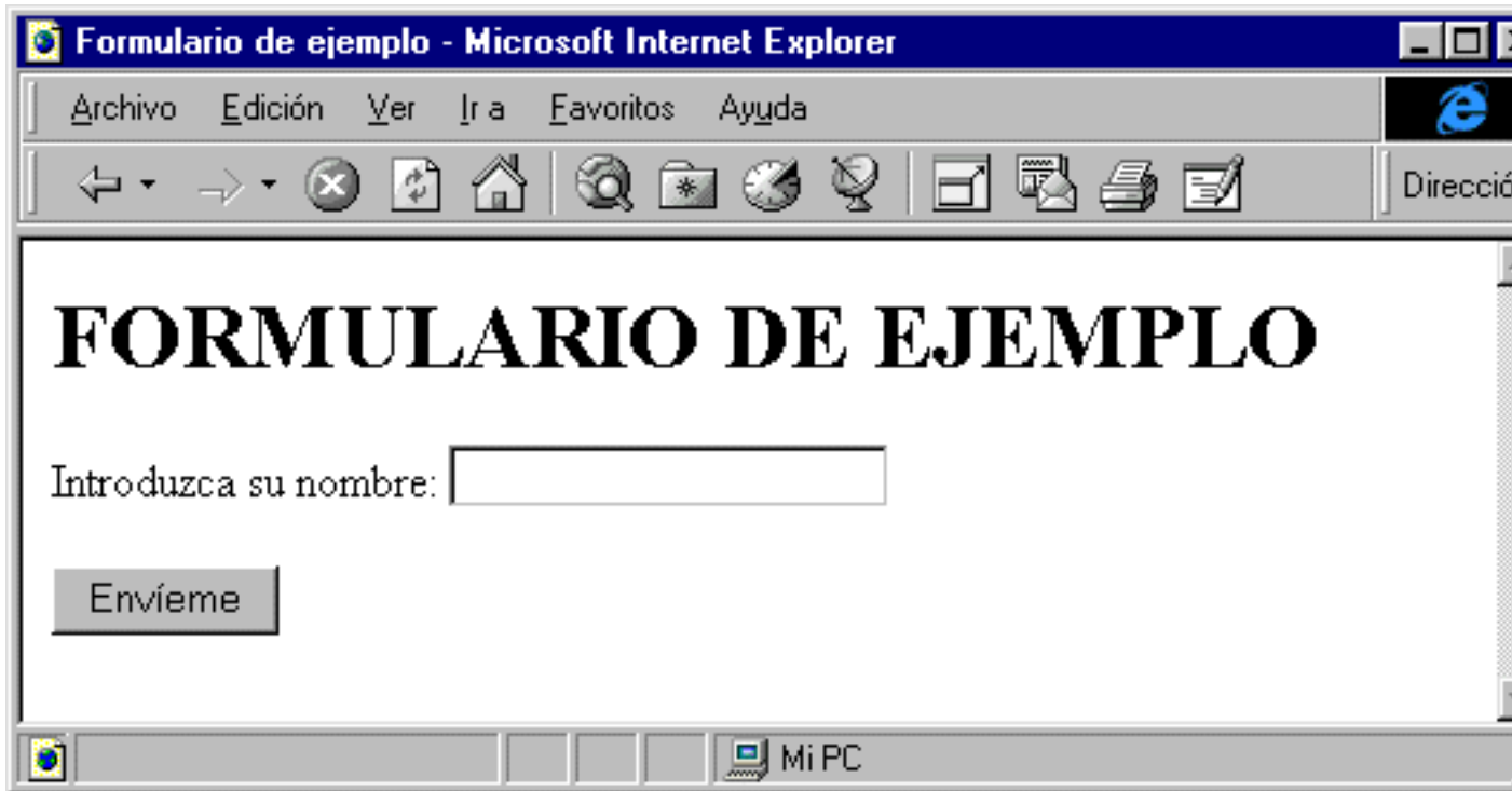
Figura 12.6. Con el atributo VALUE podemos cambiar el texto por defecto del botón de envío por uno de nuestra elección. El ancho del botón se adaptará a la longitud del texto.
