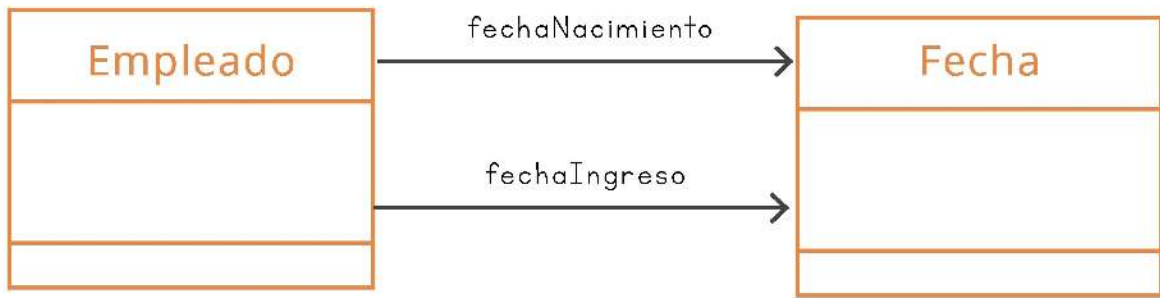
Fig. 1.8 Diagrama de clases para representar el modelo del mundo
