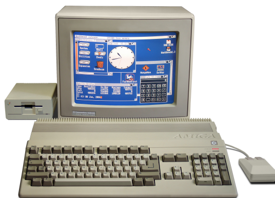
Figura 2.5: Commodore Amiga 500 (1987), la computadora más popular de la familia Amiga , con amplias capacidades multimedia y multitarea preventiva; una verdadera maravilla para su momento. (Imagen de la Wikipedia: Amiga )
